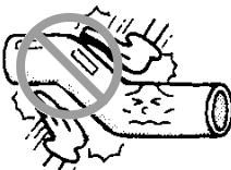
○ Для трубопровода воздуха используйте жесткие стандартные трубы для воды VP-13 (внутренний диаметр 13 мм, внешний 18 мм) из поливинилхлорида.
