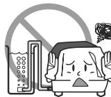
● При монтаже насоса на участке, находящемся ниже уровня воды, при остановке насоса может произойти течение потока воды в обратную сторону ввиду сифонирования. В виду попадания воды на носитель тока, обратное течение может привести к таким инцидентам, как утечка электричества, поражение электрическим током и короткое замыкание.
