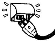
● Попадание дождевой воды непосредственно на находящиеся под напряжением детали, может привести к утечке электрического тока и/или удару им.
